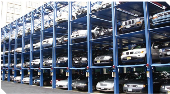
拼圖型 [原圖來源：新疆大成重科機械有限公司] Puzzle staking system [Source of the original photo: 新疆大成重科機械有限公司]
