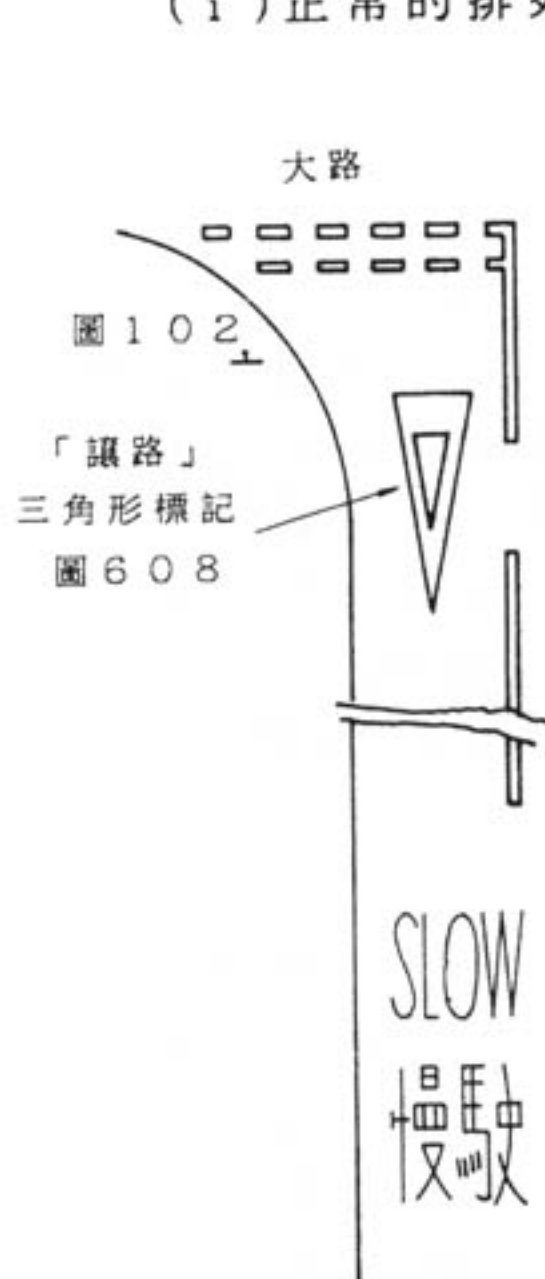
(iii) 車輛在駛往路口時車速可能較高可用「慢駛」標記
