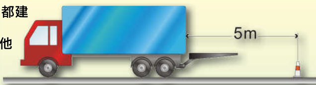
為作出預先警告而放置交通圓錐筒的示意圖
