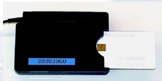
短距離微波通訊系統的聰明卡和車內裝置
