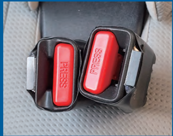
安全帶鎖扣安裝感應器以感應安全帶佩戴狀況
