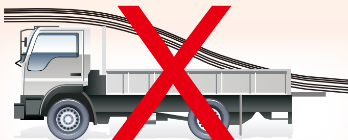
圖四：切勿只使用前檔板和敞開的後檔板承托長型金屬貨物
