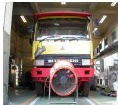
正在接受底盤功率機 測試的貨車
