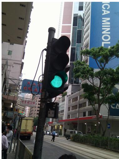
為減少耗電量，我們以發光二極管交通燈取代傳統交通燈。在 2012 年 10 月，本署的白熾燈交通燈都已置換為發光二極管交通燈。
