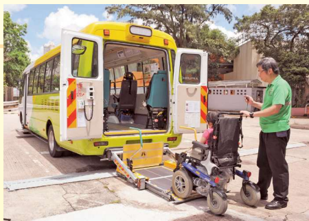
自動輪椅升降台 Automatic wheelchair lift
