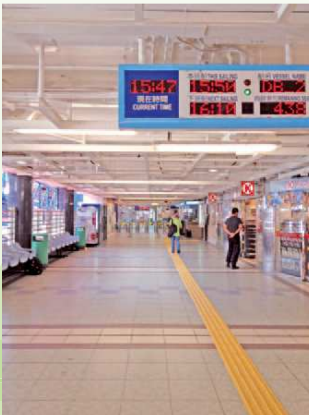
渡輪碼頭內的觸覺引路徑 Tactile guide path at pier
